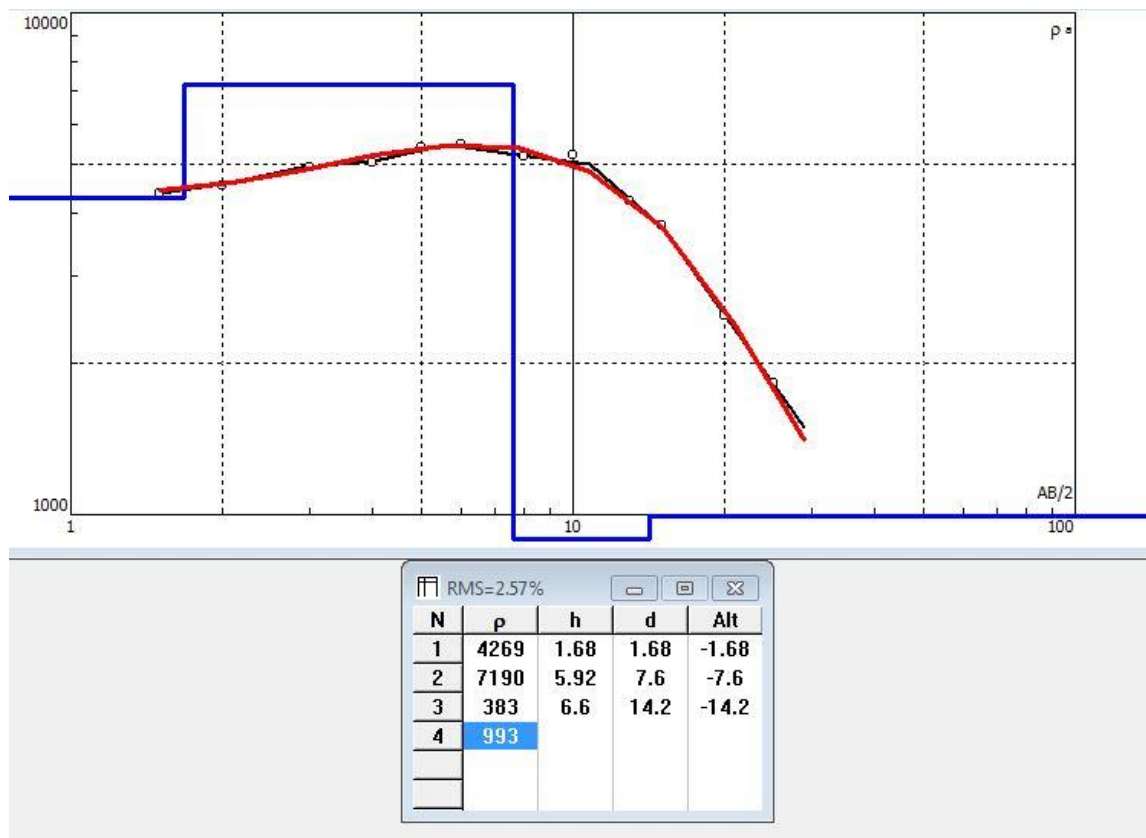
Figura 28 – Curva da SEV 9 com os respectivos valores encontrados em profundidade.
