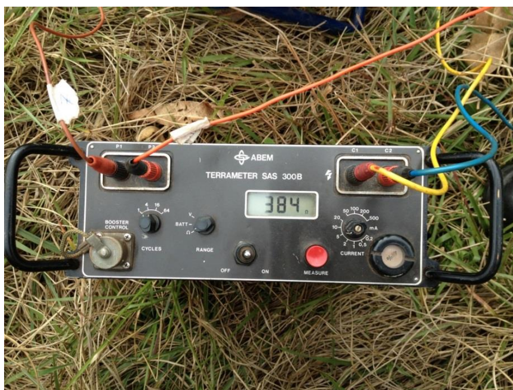
Foto 3 – Equipamento Resistímetro Terrameter ABEM Modelo SAS 300B.
